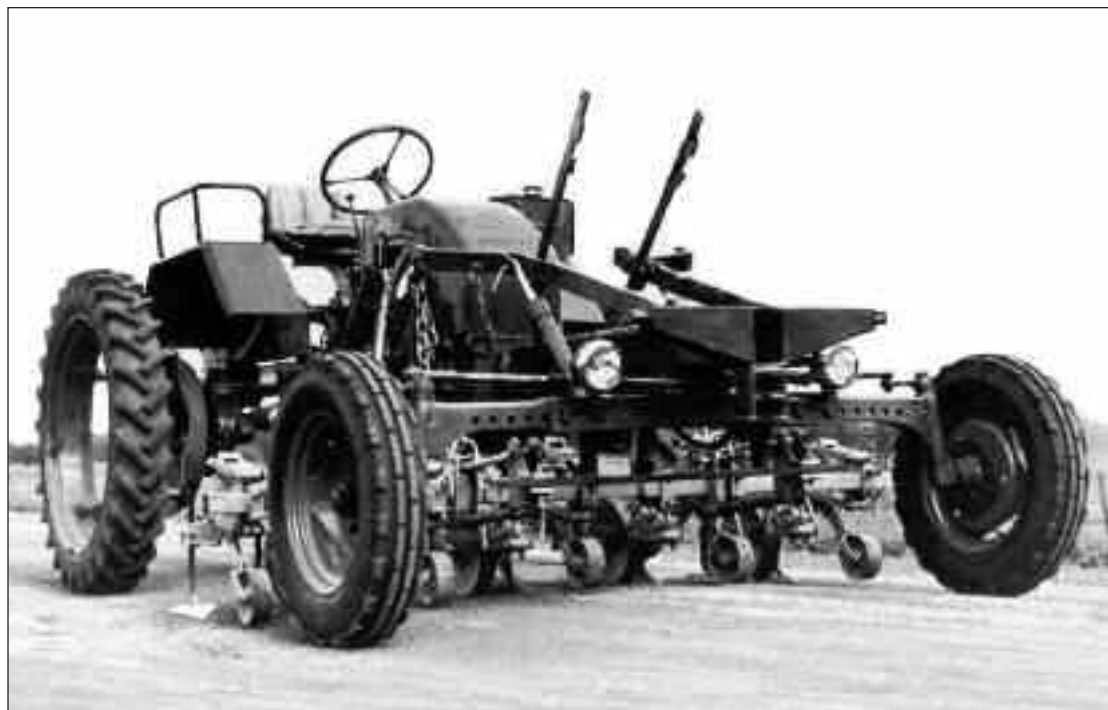
Wesseler Geräteträger mit Hackrahmen
